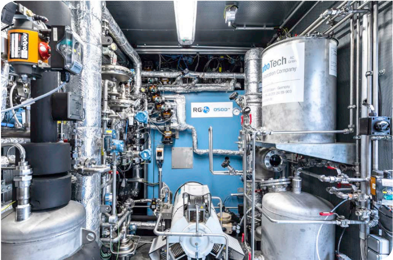
Das Innenleben des an der TU Graz entwickelten H 2 -Generators. Beim blauen Quader handelt es sich um die Kernentwicklung: einen Gasofen mit vier Rohrreaktoren, in denen der Chemical-Looping-Prozess zur Wasserstoffproduktion abläuft.
